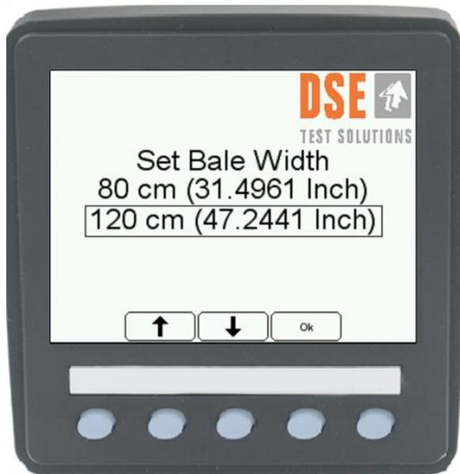
Après avoir choisi la largeur de balle appropriée à la presse et appuyé sur le bouton Ok, l'image suivante apparaîtra sur l'écran d'affichage.
