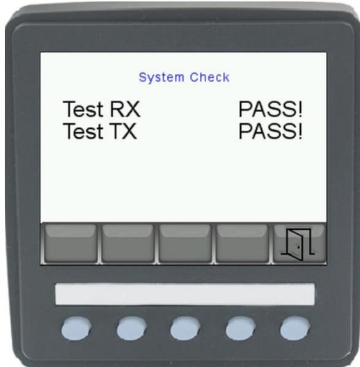
Si la connexion ne peut pas être établie, un message « FAIL ! » sera restitué.
