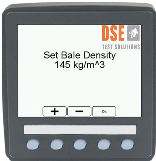
Réglez la densité de balle correcte avec les boutons + et -. Appuyez sur le bouton Ok pour le réglage suivant.
