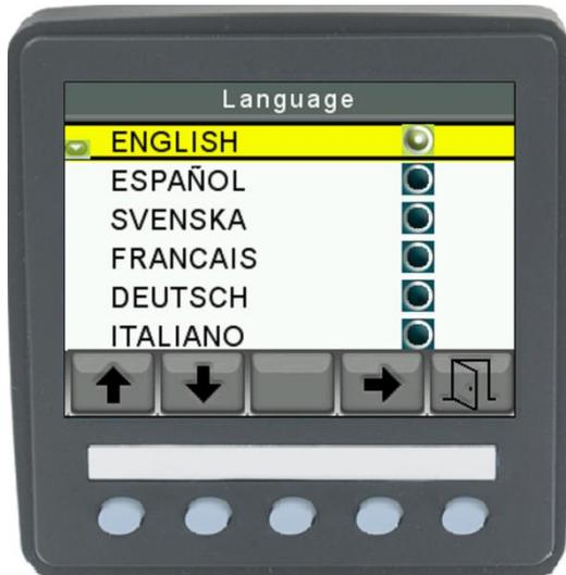
Choisissez la langue souhaitée en appuyant sur les boutons fléchés verticaux. Après avoir appuyé sur la touche fléchée horizontale pour sélectionner la langue, puis sur le symbole de la porte, le paramètre suivant apparaîtra sur l'écran d'affichage.
