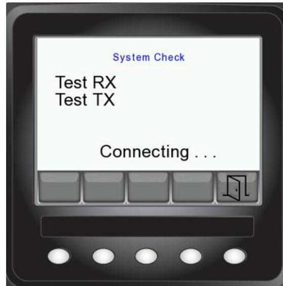
2. **Les unités ne mesurent pas !** Vérifiez les connecteurs inversés pour RX et TX. Les connecteurs sont correctement connectés lorsque le câble étiqueté RX se trouve dans l'unité RX et vice versa pour TX. Vérifiez si le connecteur entre le tracteur et la presse à balles est correctement connecté.
