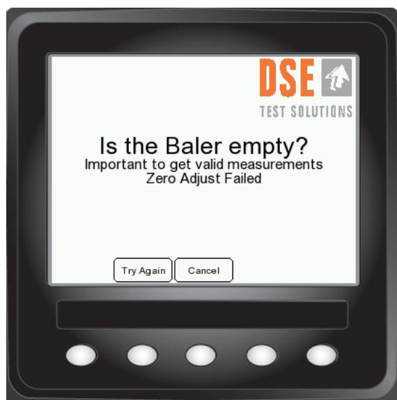
La source d'erreur la plus probable est une connexion manquante aux unités TX ou RX, du matériel dans la presse ou une perturbation similaire de la mesure.
