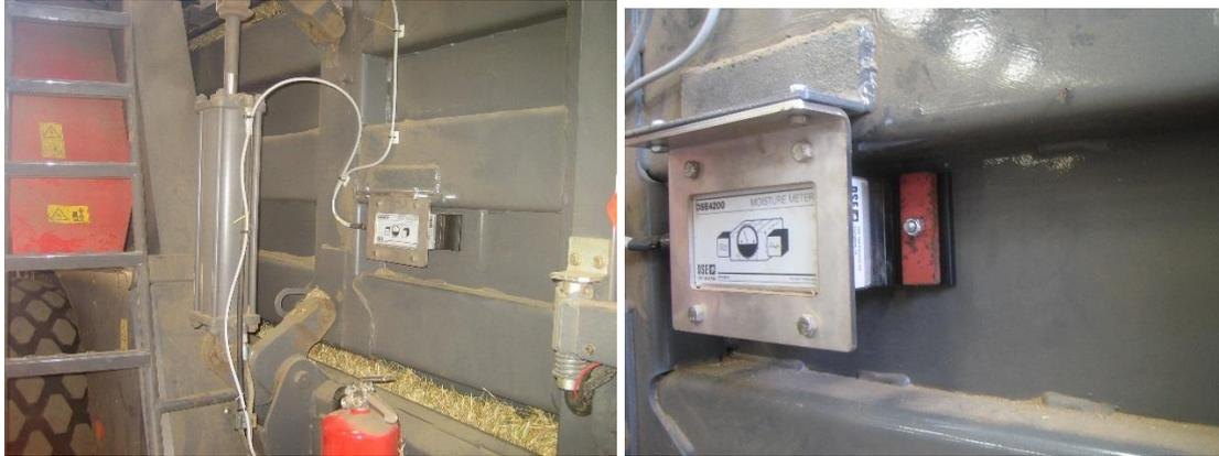
L'image ci-dessous montre l'intérieur du canal. La bande métallique soudée au mur avant l'unité TX/RX minimise l'accumulation de matériaux autour des unités TX/RX qui pourraient les endommager.
