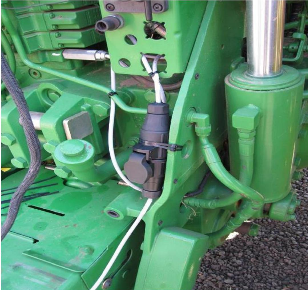
***NB : Ces connecteurs de remorque à 7 broches sont destinés uniquement au DSE4200 et ne doivent pas être connectés à un autre équipement que le DSE4200, sinon des dommages pourraient survenir.***
